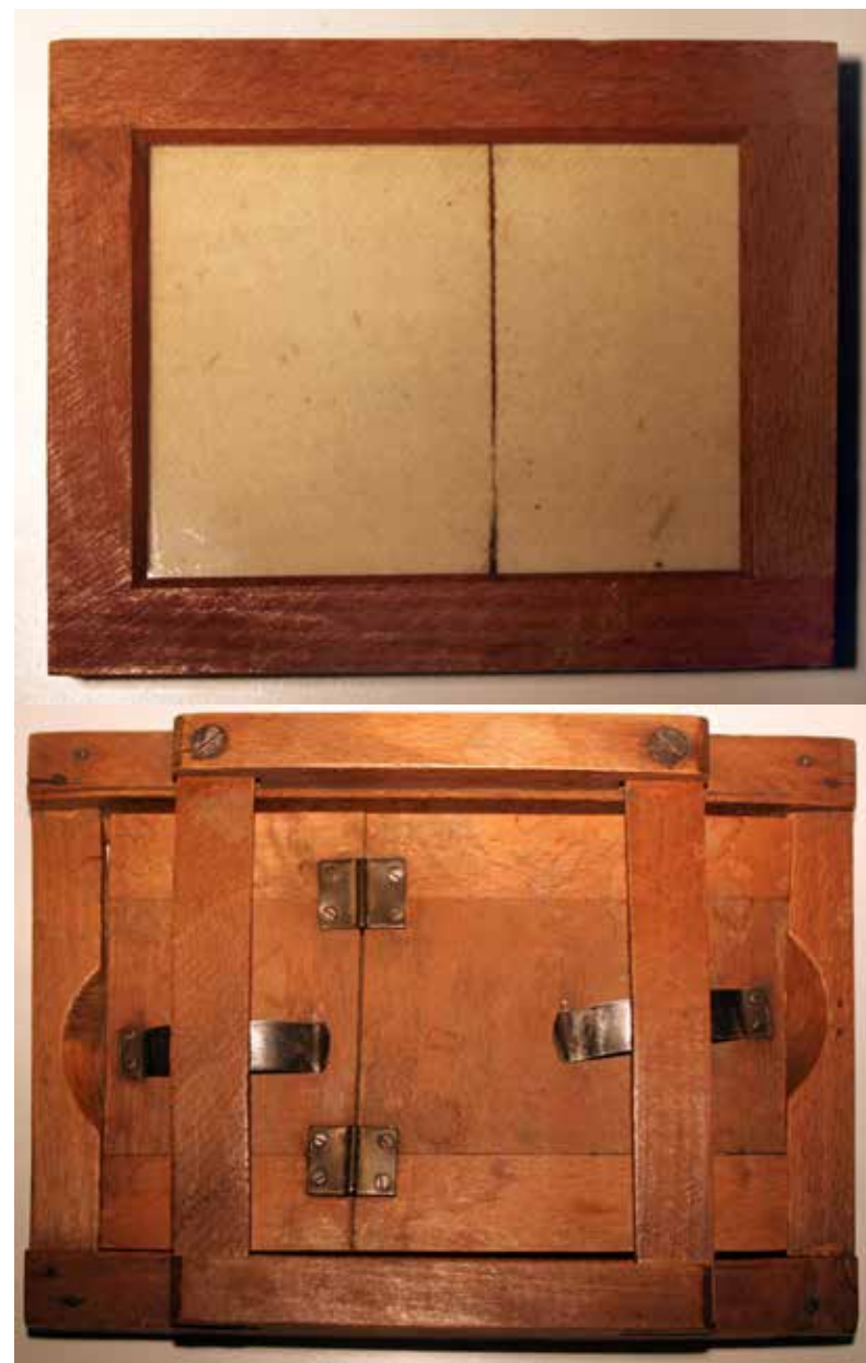
Figura 3. Chasis articulado para el positivado de copias por contacto: anverso y reverso. Colección CMP.
