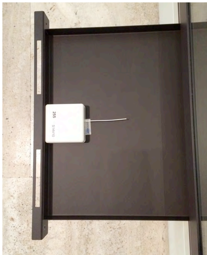
Fig. 3. Detalle de la bandeja de las vitrinas de fabricación alemana con un sensor.
