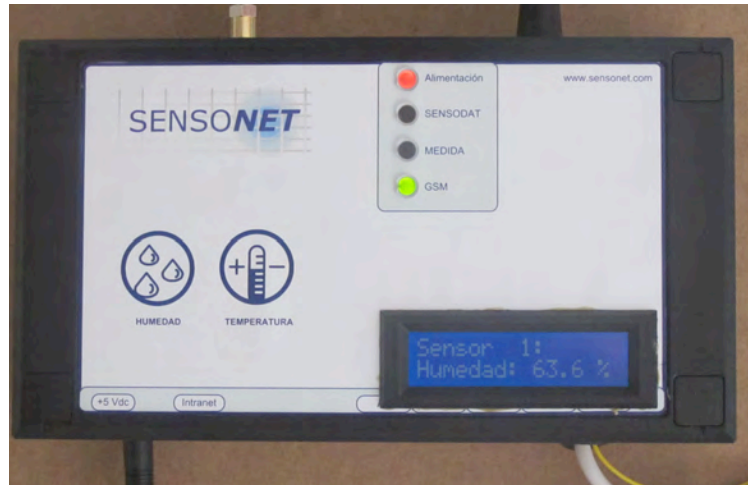
Fig. 1. Controlador del sistema Sensodat instalado en las naves de Alcalá de Henares.
