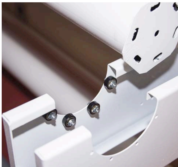
Fig. 5. Rodamientos para los tubos. Foto: Ángel Martínez Levas.
