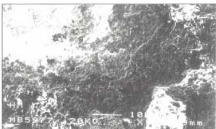
Fig. 1. Micrografía SEM de los productos de oxidación sobre el metal
