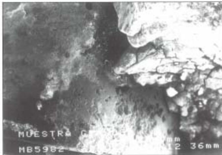
Fig. 9. Micrografía SEM de la interfase aleación metálica-material de soldadura
