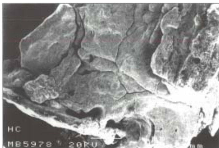
Fig. 5. Micrografía SEM del aspecto que presentaba el material utilizado para soldar
