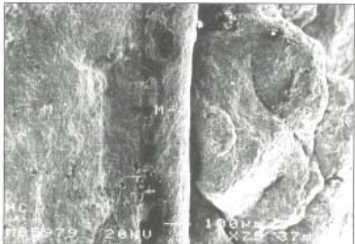
Fig. 8. Micrografía SEM de la interfase aleación metálica-material de soldadura.
