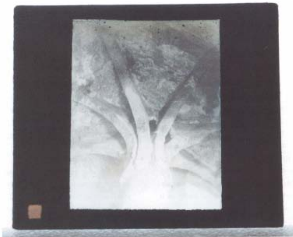
Fig. 5. N° 6 caja 13. Desvanecimiento de imagen más otros deterioros: sulfuración, espejeo de plata, cambio de color...
