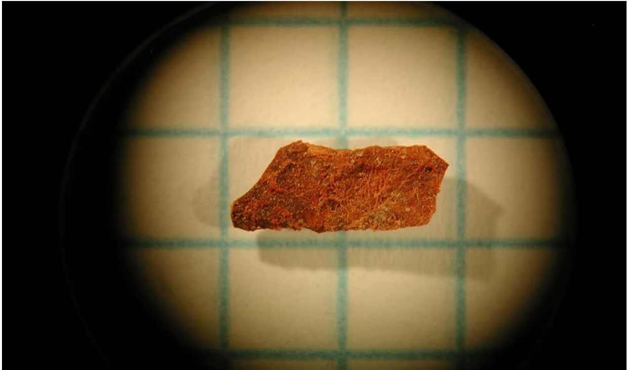
Fig. 2. Imagen de la muestra datada de 7,36 \times 3,27 mm, obtenida mediante lupa Nikon SMZ800. Peso de la muestra 6,7 mg. Foto: B. Sánchez Cabrero.
