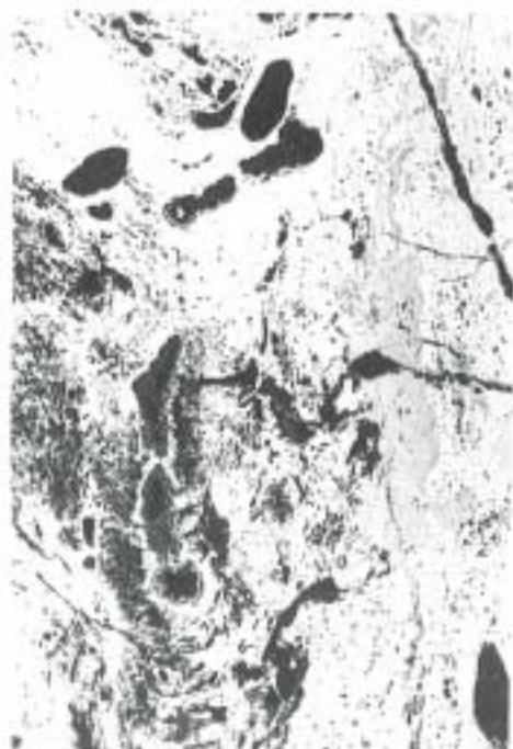
Fig. 6.—Microestructura de un freno de caballo de Fuentespreadas (Zamora).
